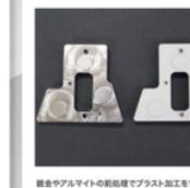
鍍金やアルマイトの剥離層をblast加工することで、光を反射させ、艶消しの効果を出します。
